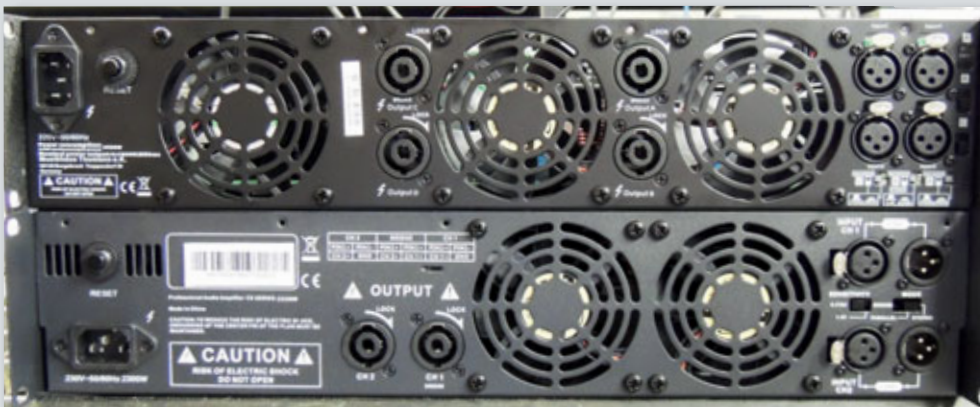
Bild 2: Auch die Rückseite zeigt, dass beide Geräte in der Fertigung „ähnlich“ aufgebaut sind (oben the t.amp TSA 4-1300, darunter DAP CX-3000)
