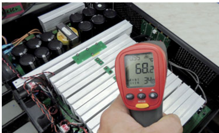
Bild 6: Hier wird es heiß – Das Infrarotthermometer zeigt 68,2°C an der Rückseite der LED-Platine bei der the t.amp TSA 4-1300 – offensichtlich werden dort Leistungswiderstände hoch belastet
